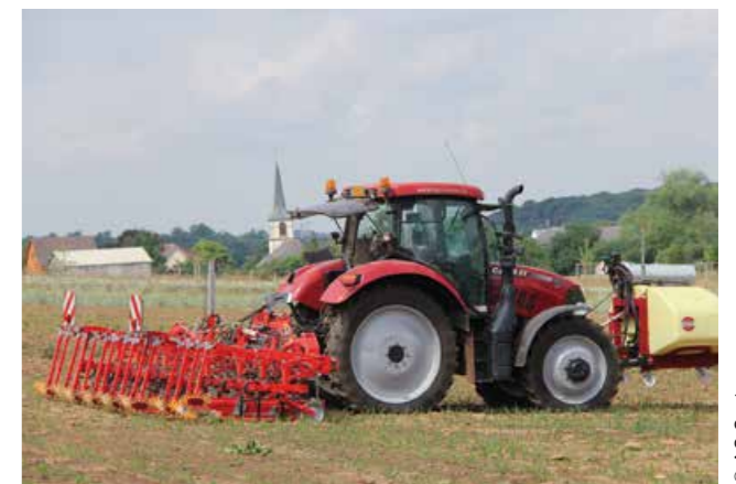
Eine landwirtschaftliche Maßnahme ist die Anschaffung einer Hackmaschine mit kombinierter Bandspritze zur mechanischen Unkrautbekämpfung im Mais. Diese Maishackmaschine zur Reduzierung der Pflanzenschutzmittel im Mais wurde 2020 von der Gemeinde Contern gekauft.
