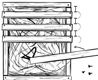
Anschließend werden die Leisten in regelmäßigen Abständen auf der Vorderseite befestigt.
