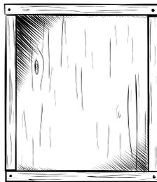
Zunächst wird ein Kasten aus den Brettern gebaut, dabei wird die Vorderseite offen gelassen. Das Dach schließt mit der Rückwand ab und steht nach vorne über.
