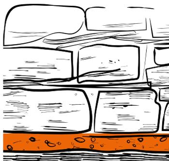
Fundament aus einer ca. 40 cm hohen Schicht aus Sand und Schotter, der gestampft und so verdichtet wird (bei stark verdichtetem Untergrund nicht notwendig). Fundamentsteine werden in den Boden eingelassen.
