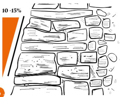
Steine passformgenau setzen, regelmäßig Bindersteine setzen, die über mehrere darunter befindliche Steine reichen. Hintermauerung sorgfältig schichten. Anlauf von 10-15% einhalten.
