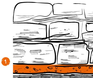
Fondations constituées d'une couche de sable et de gravier d'environ 40 cm de hauteur, tassée et ainsi compactée (pas nécessaire si le sol est déjà fortement compacté). Les pierres de fondation sont enfoncées dans le sol.
