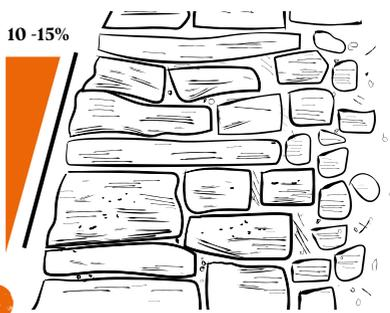
Poser les pierres avec précision, placer régulièrement des boutisses parpaigne, stratifier soigneusement les pierres de remplissage. Respecter une inclinaison de 10-15%.
